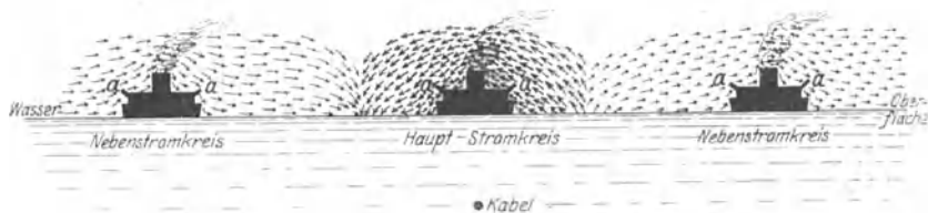
Abb. 43. Die Kraftlinien des magnetischen Überwasser-Feldes und ihr Verlauf um den Schiffskörper. a = Auffangspule.
