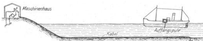
Abb. 42. Elektrische Leitkabel auf dem Boden einer Hafenzufahrtstraße.
