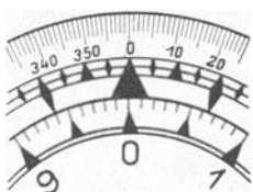
Abb. 58. Minutenrose eines Tochterkompasses.
