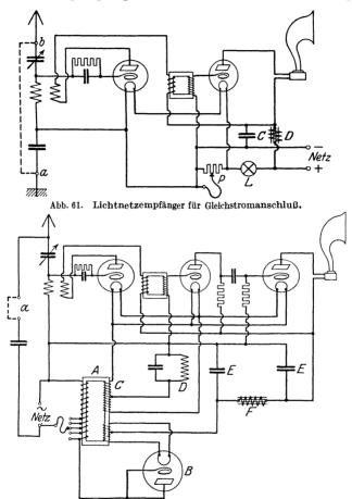
Abb. 62. Lichtnetzempfänger für Wechselstromanschluß.
