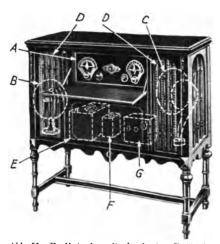
Abb. 51. Radiotruhe mit eingebauten Batterien und Lautsprechern. A Empfänger, B Konuslautsprecher, C Trichterlautsprecher, D Schallöffnungen, mit Stoff verkleidet, E Heizbatterie, F Ladeeinrichtung für Dauerladung der Heizbatterie, G Anodenbatterie oder Netzanschlußgerät für den Anodenstrom.
