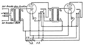
Abb. 38. Niederfrequenzverstärker, dessen Röhren mit Hilfe densten Umschalvon Klinkenschaltern einzeln abgeschaltet werden können.
