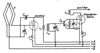
Abb. 33. Tropadyneschaltung mit abgestimmter Vorröhre in Dreipunktschaltung.
