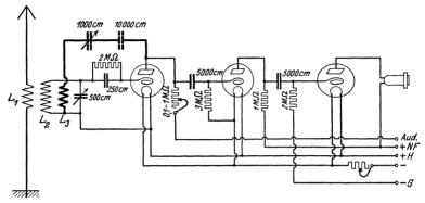
Abb. 3. Schaltung des verbesserten Widerstandsempfängers mit kapazitiv regelbarer Rückkopplung.
