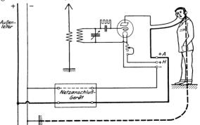
Abb. 47. Weg des Erdschlußstromes beim Gebrauch eines Netzanschlußgerätes für Gleichstrom bei geerdetem Minusleiter und zufälligem Erdschluß des Kopfhörers.
