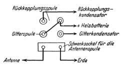
Abb. 10. Die Verbindung der Spulensteckbuchsen in Schaltung Abb. 3 mit den übrigen Teilen des Empfängers.
