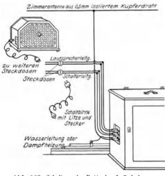
Abb. 108. Schaltung des Batterieschränkchens der Abb. 107.
