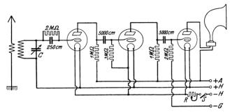
Abb. 58. Widerstands-Verstärkerschaltung für den automatischen Ortsempfänger.
