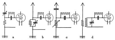
Abb. 11a bis d. Gebräuchliche Antennenschaltungen. d = am empfehlenswertesten.
