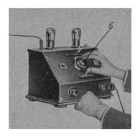
Abb. 2. Die Bedienungsgriffe bei einem guten Rückkopplungsempfänger mit Einfach-Niederfrequenzverstärkung: I Einschalten der Heizung, 2 Einregulieren des Heizstromes, 3 Bedienung der Antennenkopplung, 4 Bedienung der Rückkopplung, 5 Einstellen des Wellenbereiches, 6 Abstimmen auf die Senderwelle.
