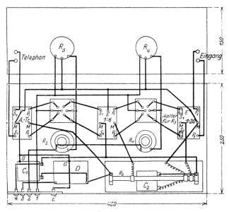
Abb. 75. Bauplan für den Gegentakt-Niederfrequenzverstärker nach Abb. 60.
