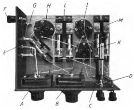
Abb. 5. Innenansicht eines selbstgebauten Widerstandsempfängers nach Schaltung Abb. 3 mit Kondensatoren der Abb. 4. A Abstimmkondensator. B Rückkopplungskondensator, C Heizwiderstand, D Batterieklemmen, E Steckbuchsen für die Spulen, F Antenner-, G Erdklemme, H, I, K Röhrenfassungen, L, M Kopplungsglieder, bestehend aus Anodenwiderstand, Blockkondensator un i Gitterwiderstand.
