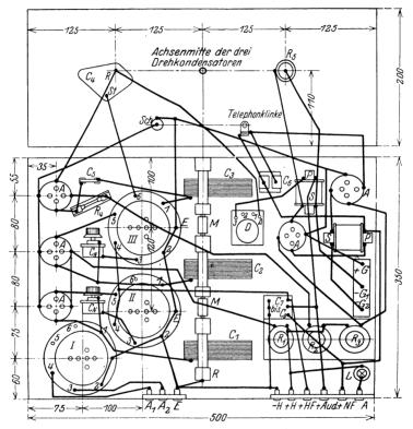
Abb. 84. Bauplan für den Solodyne-Empfänger.
