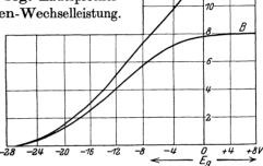
Abb. 8. Statische (A) und Arbeitscharakteristik einer Hochvakuumröhre.  $R_{\sigma}=2850$  Megohm,  $R_{g}=3$  Megohm (RE 504).
