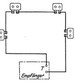
Abb. 100. Verteilungsschaltung unter Benutzung der Steckdose Abb. 99.
