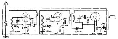
Abb. 29. Schaltung eines geschirmten Dreiröhren-Neutrodyne-Empfängers (Gerät des Telegraphentechnischen Reichsamts).
