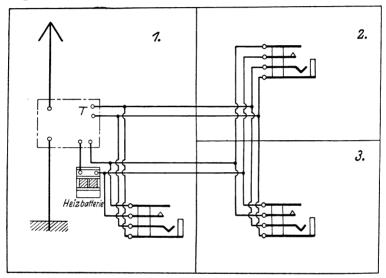
Abb. 95. Verteilungsschaltung mit Klinkenschaltern zur automatischen Einschaltung des Heizstromes.
