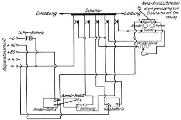
Abb. 89. Schaltung einer automatischen Ladevorrichtung für Heiz- und Anodenakkumulator (Accumulatorenfabrik A.-G., Berlin-Oberschöneweide).
