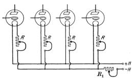
Abb. 53. Parallelschaltung von Röhren, die jede ihren besonderen Heizwiderstand R erhält. Kompensierung des Spannungsabfalls der Heizbatterie durch den gemeinsamen Zusatzwiderstand  $R_1$ .
