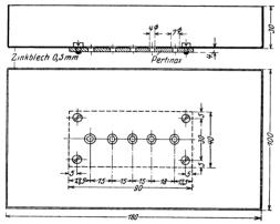
Abb. 26. Unterteil eines Abschirmkastens für den Hochfrequenztransformator nach Abb. 28.
