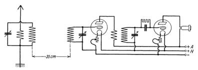
Abb. 25. Versuchsanordnung zur Ermittlung der Streuung von Ledionspulen.
