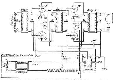
Abb. 59. Schaltung eines Zweifach-Gegentaktverstärkers mit Vorrichtung zur Entnahme der Heiz- und Anodenspannung aus dem Gleichstromnetz (nach Dr. Dietz).
