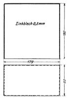
Abb. 27. Oberteil eines Abschirmkastens für den Hochfrequenztransformator nach Abb. 28.
