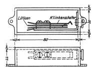
Abb. 102. Klinkenschalter im Isoliergehäuse zur Wandmontage.
