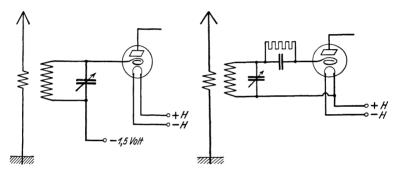
Abb. 9a und b. Die Schaltung der ersten Röhre des Widerstandsempfängers als Anodenstromgleichrichter (a) und als Audion (b).
