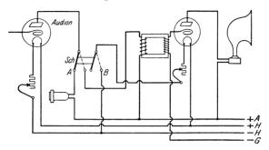
Abb. 37. Niederfrequenzverstärker; letzte Stufe durch Knebelschalter abschaltbar.
