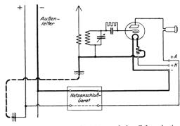
gen besitzen muß, Abb. 46. Weg des Erdschlußstromes beim Gebrauch eines Empfangsanlage und Netzanschlußgerätes für Gleichstrom und geerdetem Plusleiter.
