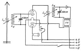
Abb. 18. Empfangsgerät mit Doppelröhre: 1 HF + Detektor + 1 NF.
