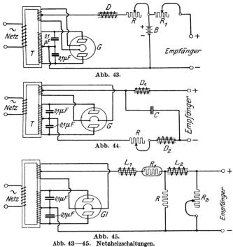
Selbstinduktion der aus Abb. 43 haben, um die gleiche Wirksamkeit zu erlangen, wie sie die Schaltung mit Ausgleichsbatterie besitzt.
