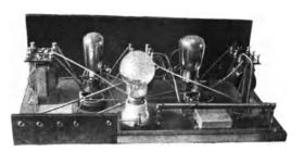
Abb. 77. Der fertige Niederfrequenz-Gegentaktverstärker.
