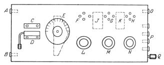
Abb. 34. Einbauskizze für einen Widerstands-Ortsempfänger vollkommen geschlossener Ausführung. A Antennen-, B Erdklemme, C Gitter-, D Antennenspule, E Drehkondensator, F, G, H Röhrenfassungen, I, K Widerstands-Kopplungselemente, L, M, N Heizwiderstände, O Telephon-, P Batterieklemmen, Q Zentralschalter.
