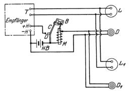
Abb. 98. Schaltung einer Anlage mit Fernschalter nach Abb. 97.
