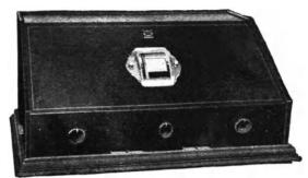
Abb. 82. Fünfröhren-Neutrodyne-Einknopfempfänger Telefunken 9 (Telefunken G. m. B. H., Berlin).
