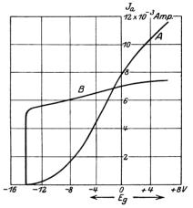
Abb. 7. Statische (A) und Arbeitscharakteristik (B) einer gashaltigen Röhre  $R_{\sigma}=2850$  Ohm,  $R_{\theta}=3$  Megohm.
