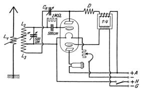
Abb. 15. Doppelröhren-Rückkopplungsempfänger mit Einfach-Niederfrequenzverstärkung.
