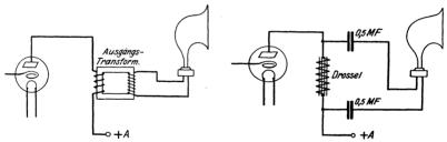
Abb. 49. Die Einschaltung eines Ausgangstransformators in den Anodenkreis der letzten Röhre.
