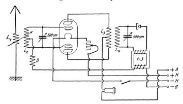
Abb. 19. Doppelröhren-Gegentaktempfänger.
