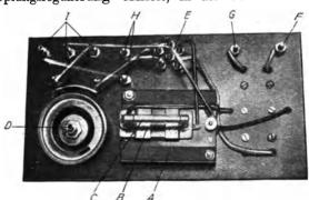
Abb. 17. Rückansicht des Reiseempfängers der Abb. 16. A Abstimmdrehkondensator, B Gitterkondensator mit Gitterwiderstand C, D Heizwiderstand, E Röhrenfassung, F Antennen-, G Erdklemme, H Telephon-, I Batterieklemmen.
