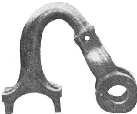
Eine beim Anlassen gebogene Pleuelstange einer Kreuzkopfmachine.
