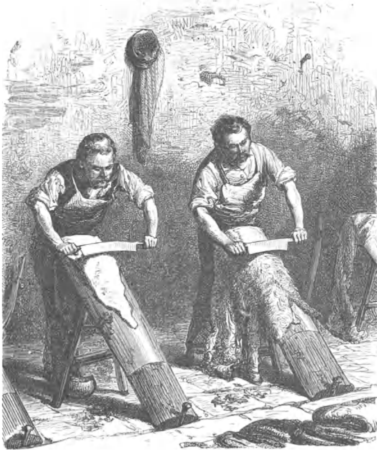
Fig. 404. Arbeiten am Schabebaum.
