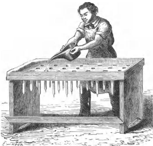
Fig. 218. Gießen der Lichter.
