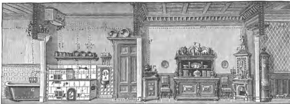
Fig. 344. Wasserheizung vom Küchenherd aus.
