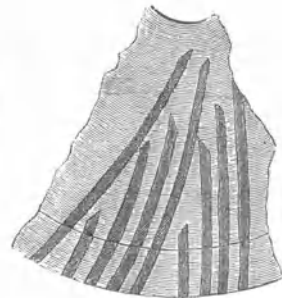
Fig. 18 und 19. Schärfung der Mühsteine.
