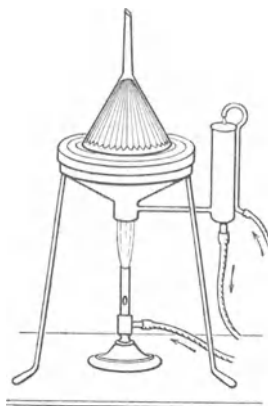
Fig. 15. Erwärmen von Trichter mit Filter auf dem Warmbade.
