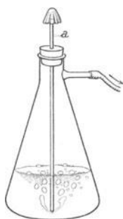
Fig. 87. Entfernung von Schwefelwasserstoff durch Durchsaugen von Luft.
