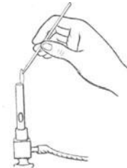
Fig. 35. Zuschmelzen des Schmelzpunktröhrchen.
