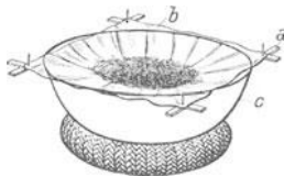
Fig. 76. Filtration durch Koliertuch auf Filtrierrahmen.
