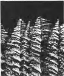
(s. Anhang) kann man im Schliiff in den einzelnen Schichten den Unterschied an Fremdbestandteilen — außer C auch P, S usw. — und damit das Wachstumsgefüge der Kristalle sichtbar machen. Es erinnert an Tannenbäumchen
