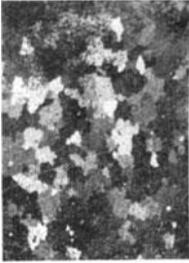
Abb. 106.  $V = 1$ . Sehr grobkörniger Ferrit ( $\rho = 6 \text{ mm} = 26 \cdot 10^6 \mu^2$ ). Tiefätzung bei schräger Beleuchtung. Transformatorblech mit 4% Si.
