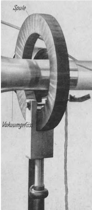
Abb. 10. Ausführung einer einfachen Spulenlinse. (Kurze Spule.)
