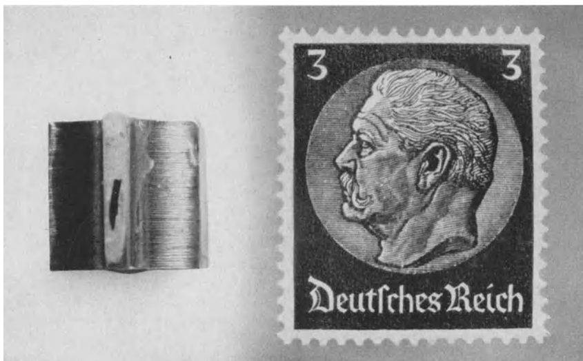
Abb. 249. Schneidfertiges, eingebettetes und aufgeblossenes Objekt.
