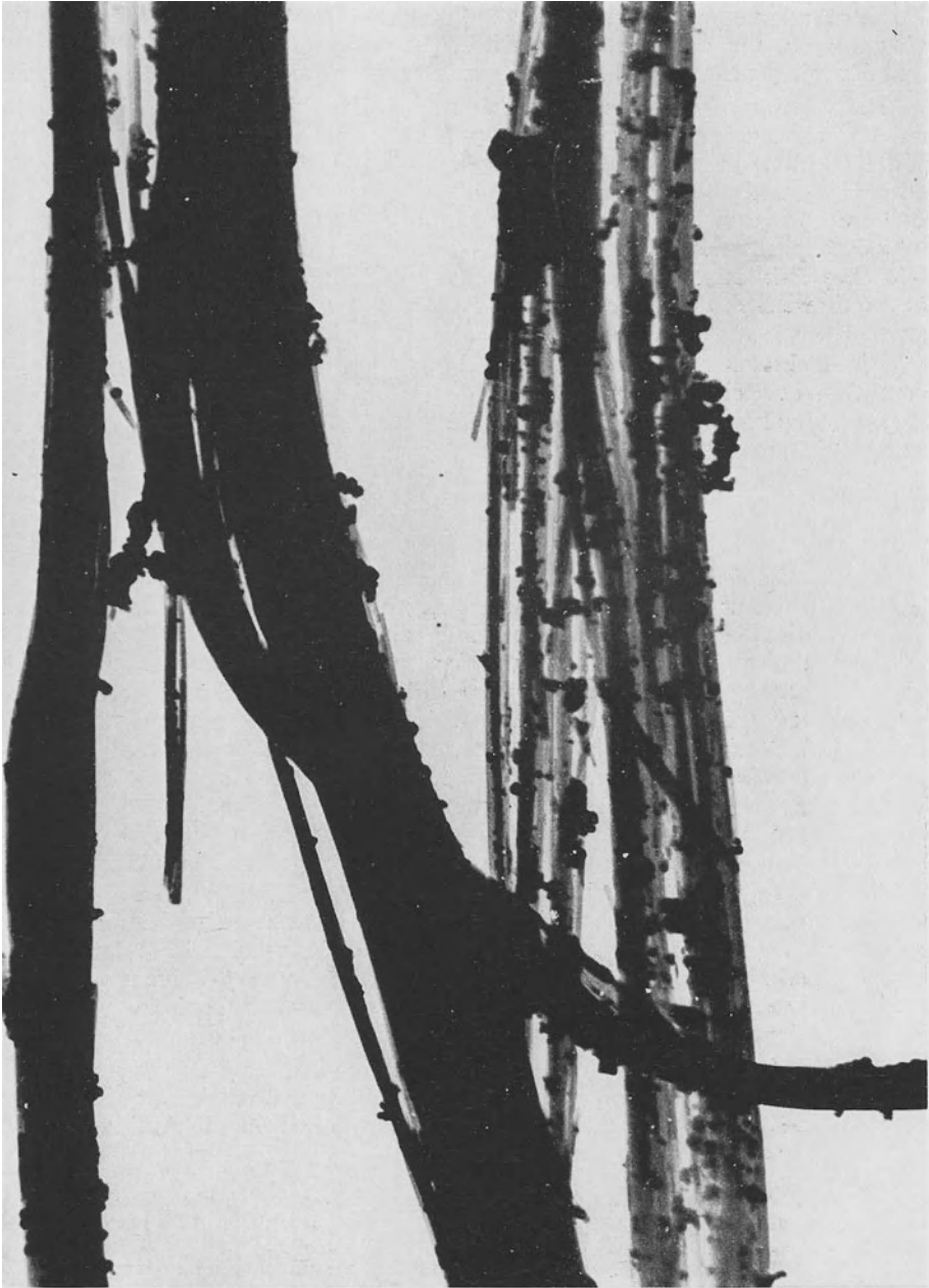
Abb. 323. Unbenutzter Palladiumasbestkatalysator. In dieser Abbildung ist der überwiegende Teil des ganzen Gesichtsfeldes wiedergegeben. Man erkennt das relativ zur Bildscharfe außerordentlich große Gesichtsfeld. (Aufnahme v. ARDENNE, Präparat BEISCHER.)
