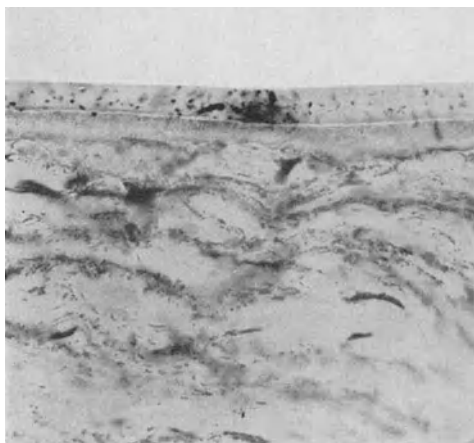
Abb. 96. Verteilung der Körnschwärzung nach Bestrahlung mit einer 50 kV-Elektronenonde. (Osziloxschicht.)
