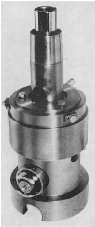
Abb. 185. Außenansicht der Kondensoreinheit.
