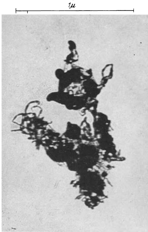
Abb. 338. Stark mit Licht belichtete, entwickelte, unfixierte Bromsilberkörner mit feinen 10—15 \mu dicken (Silber-?) Fäden. (Aufnahme v. ARDENNE.)
