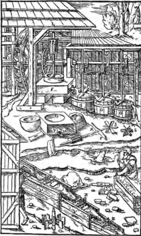
Fig. 22. Goldgewinnung mittels Amalgamationsverfahrens nach einem Holzschnitte vom Jahre 1552.
