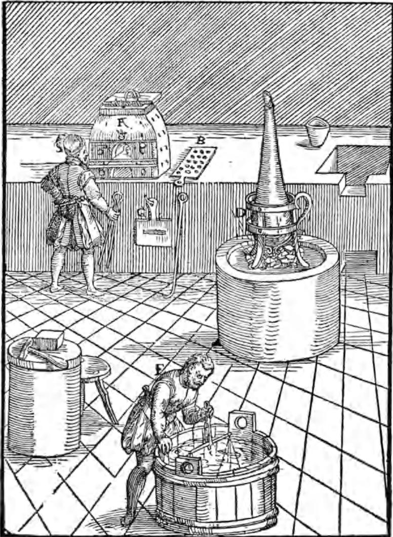
Fig. 20. Untersuchung einer Goldlegierung nach einem Holzschnitte vom Jahre 1598.<sup>1)</sup>
