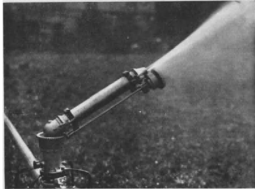
Abb. 120. Schmutzwasserweitstrahlregner der Fa. Lanninger AG, Frankfurt-Rödelheim.
