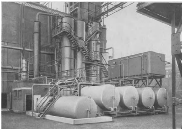
Abb. 56. Entphenolungsanlage mit stehenden Wäschern für eine Leistung von 800 cbm Ammoniakwasser in 24 Stunden. Die Anlage bezweckt, mit Benzol als Waschmittel, die Gewinnung von Natrium-Phenolat.
