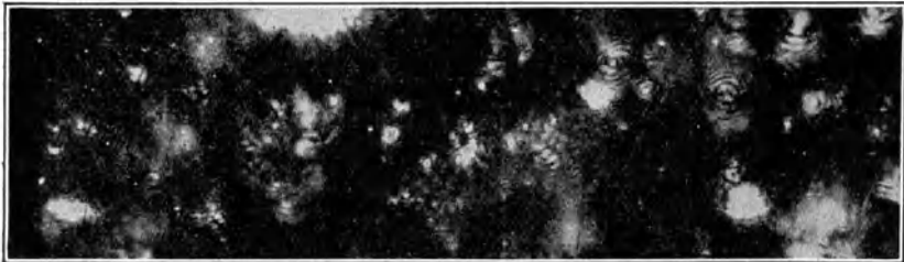
Abb. 257. Ultramikroskopische Struktur der Kollodiumseide.
