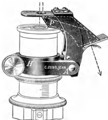
Abb. 7. Projektionsaufsatz für Mikrogramme. (C. Zeiss, Jena.)
