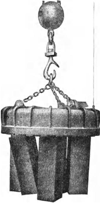
**Bedienung** der Hebemagnete: Sie ist sehr einfach, weil der Kranführer nur einen Stromschalter zu bedienen hat, um den Magnet zu erregen.
