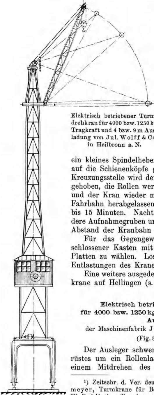
Elektrisch betriebener Turmdrehkran für 4000 bzw. 1250 kg Tragkraft und 4 bzw. 9 m Ausladung von Jul. Wolff & Co. in Heilbronn a. N.
