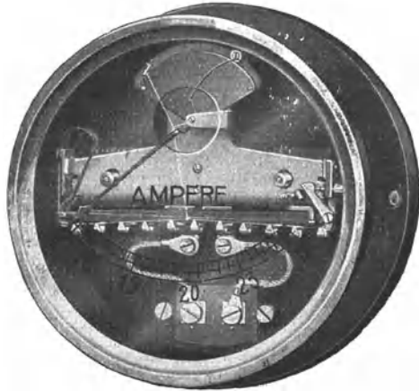
Fig. 127. Hitzdrahtinstrument mit durchsichtiger Skala zur Demonstration des Innern.
