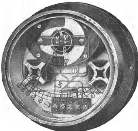
Fig. 139. Phasenzeiger mit Glasskala zur Demonstration der Innenteile.
