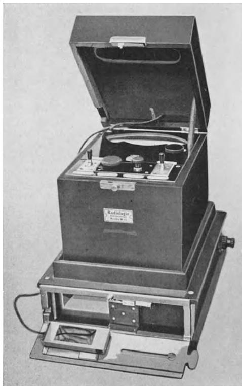
Abb. 19. Intensimeter nach FÜRSTENAU.
