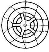
Abb. 22. Geteilte Schnittplatte, unterer Teil als Amboßplatte dienend.
