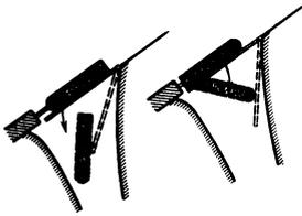
Abb. 198. Ordnen unter Benutzung der Werkstückform.
