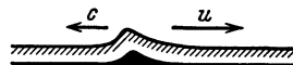
Abb. 520. Hydraulischer Wassersprung. Zur Veranschaulichung eines Verdichtungsstoßes in einem mit Überschallgeschwindigkeit strömenden Gase. Die Strömungsgeschwindigkeit u ist größer als die Geschwindigkeit c der Oberflächenwellen [Gleichung (198) v. S. 162]. Infolgedessen kann sich die bei dem Hindernis ausbildende Störung nicht stromaufwärts bemerkbar machen.
