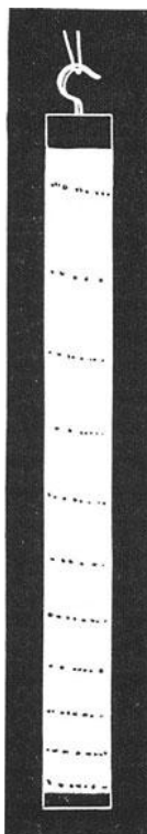
Abb. 29. Fallkörper mit Zeitmarken und deren Auswertung mit den üblichen Versuchs- und Ablesungsfehlern. Dieser Versuch soll vor allem zeigen, daß die Messung eines zweiten Differentialquotienten stets eine mißliche Sache ist.
