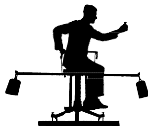
Abb. 175. Ein Drehstuhl mit hohem Trägheitsmoment zur Vorführung von Corioliskräften. Die hier photographierten Zusatzmassen benutzt man zweckmäßig auch bei den in den Abb. 165, 169, 171, 174 dargestellten Versuchen.
