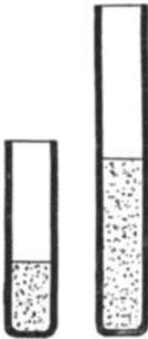
Abb. 70. Sprengkapseln Nr. 3 u. 8 in natürlicher Größe.
