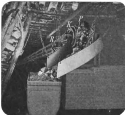
Abb. 288. Stahlgliederband mit Austrag über dem Antrieb.
