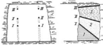
Abb. 84. Einbruch am Liegenden.
