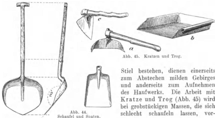
Stiel bestehen, dienen einerseits zum Abstechen milden Gebirges und anderseits zum Aufnehmen des Haufwerks. Die Arbeit mit Kratze und Trog (Abb. 45) wird bei grobstückigen Massen, die sich schlecht schaufeln lassen, vorgezogen.
