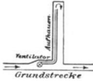
Abb. 166. Anschluß der Sonderbewetterung an den Hauptstrom.
