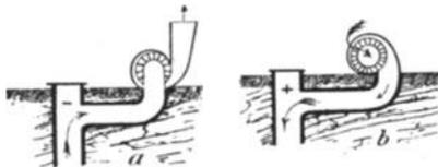
Abb. 148 a u. b. Darstellung des saugend und des blasend angeordneten Ventilators.
