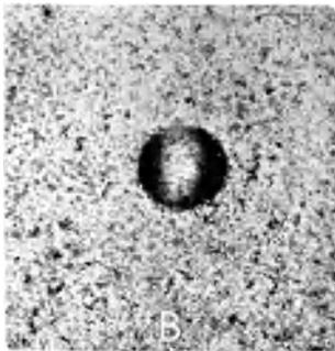
Abb. 23. Gefügebild bei Zeitprüfung auf ausgeglühtem Kohlenstoffstahl. 50 ×.
