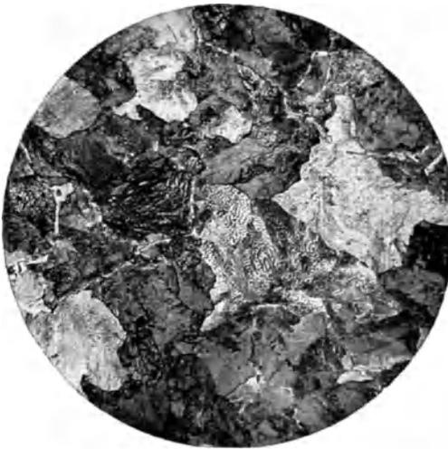
Abb. 113b. Sorbit mit feinlamellarem Perlit.<sup>2)</sup>
