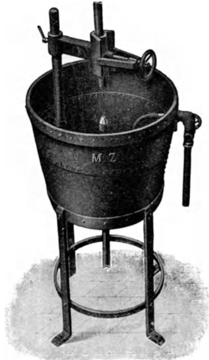
Abb. 99. Wasserstrahlvorrichtung zum Härten von Döppern.
