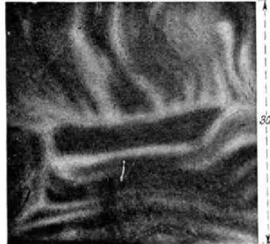
Abb. 26. Schweißstahl (Gärbstahl).
