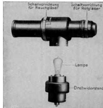
Abb. 88c. Lichtbild der neuen Ausführung des Glühfaden-Pyrometers von Siemens & Halske.
