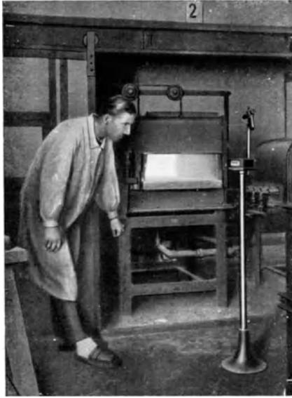
Abb. 84. Temperaturmessung mit dem Ardometer an einem Glüh- und Härteofen von Siemens & Halske.
