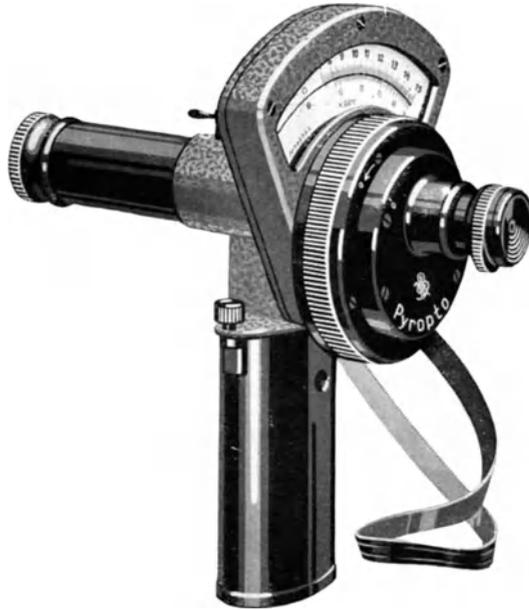
Abb. 90. Ausführungsform des Optischen Pyrometers „Pyropto“ von Hartmann & Braun.
