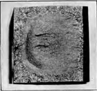
Abb. 159. Grobkörniger Bruch an Kanten und Ecken eines eingesetzten Stahles; es wurde zu hohe Glüh-temperatur angewendet. (Aus Schäfer, Konstruktionsstähle.)
