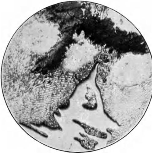
Abb. 2. Der glatte weiße erhabene Teil ist Eisenkarbid (sog. Cementit), der glatte vertiefte weiße Teil ist kohlenstoffreies Eisen (Ferrit), der schwarze ist Temperkohle Vergrößerung = 500. (Aus Wawrziniok, Handbuch des Materialprüfungswesens.)
