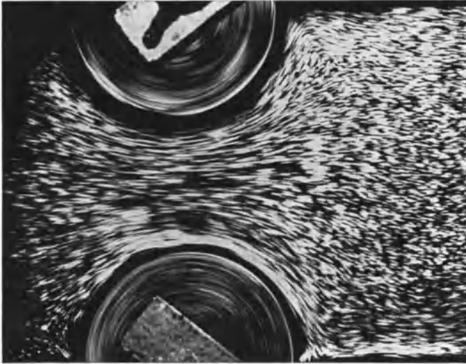
Abb. 119. Kanal durch rotierende Walzen verengt. Strömung legt sich wieder an. (Verlustfreie Drosselstelle.)
