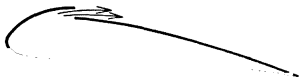
Abb. 120. Blasflügel. Abreißen der Strömung wird verhindert durch Einblasen von Frischluft auf die Saugseiten.
