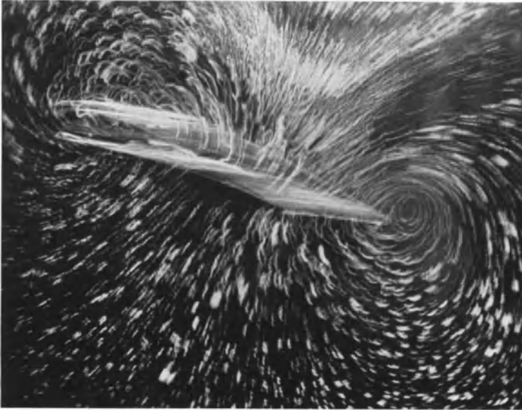
Abb. 97. Strömungsbild kurz nach dem Start. Der Zirkulationswirbel und Anfahrwirbel sind deutlich zu erkennen.
