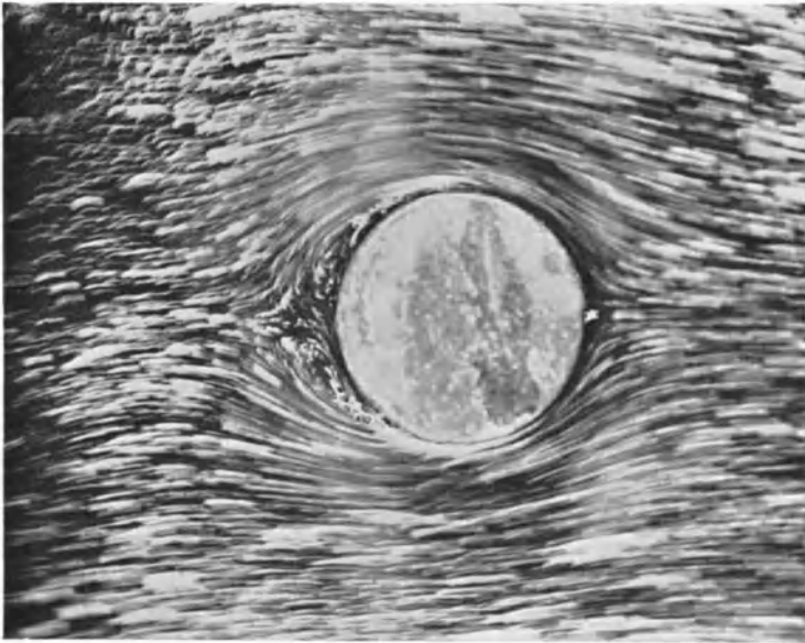
Abb. 87. Zylinderströmung im ersten Augenblick der Bewegung.
