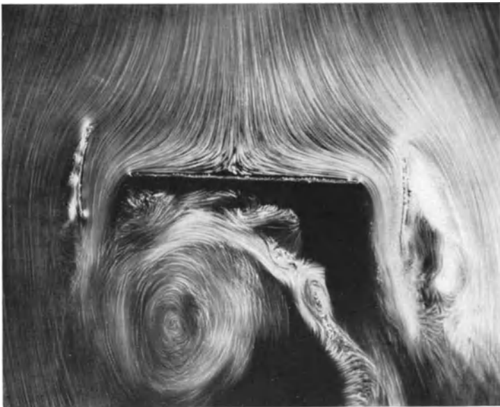
Abb. 124. Günstigste Stellung der Hilfsflügel für die Kreisplatte. An den Hilfsflügeln löst sich die Strömung ab. (Unterschied zwischen ebenem und rotationssymmetrischem Problem!)
