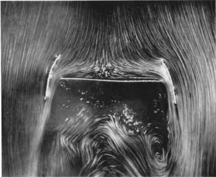
Abb. 123. Hilfsflügel verhindern das weite Ausweichen der Strömung nach Abb. 122 und vermindern den Widerstand um 50%.
