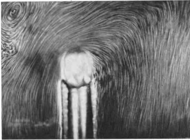
Abb. 117. Ablösungsfreie Umströmung einer Wand durch Absaugen am Kopf der Trennwand. Umströmung im Uhrzeigersinne.
