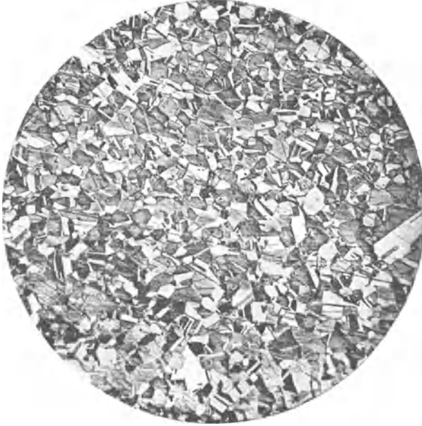
Abb. 94. Kleingefüge von Kupfer, ungeschweißtes Material (115fache Vergrößerung).
