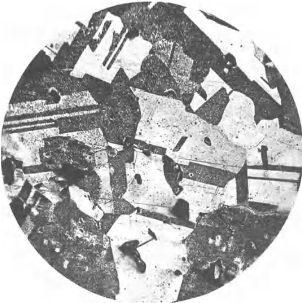
Abb. 95. Grobkristallinisches Kleingefüge der frischen Kupferschweißnaht (115fache Vergrößerung).
