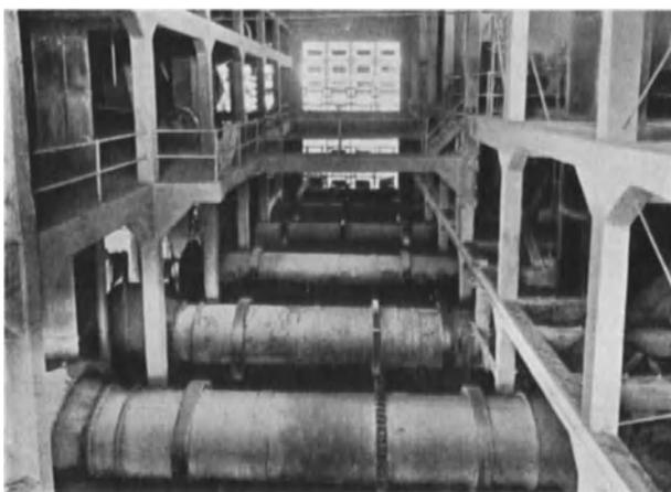
Abb. 95. Trockenanlage für Phosphat in Florida.
