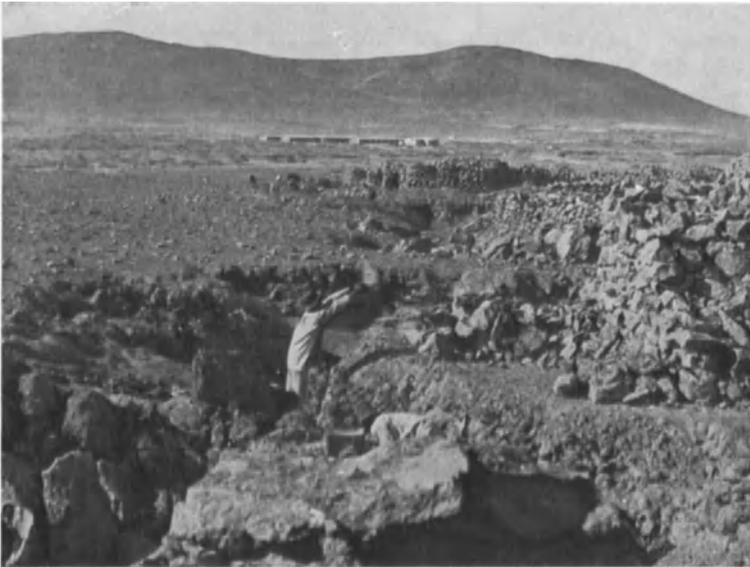
Abb. 162. Der Abbau des Rohstoffes (Caliche) in Gruben.
