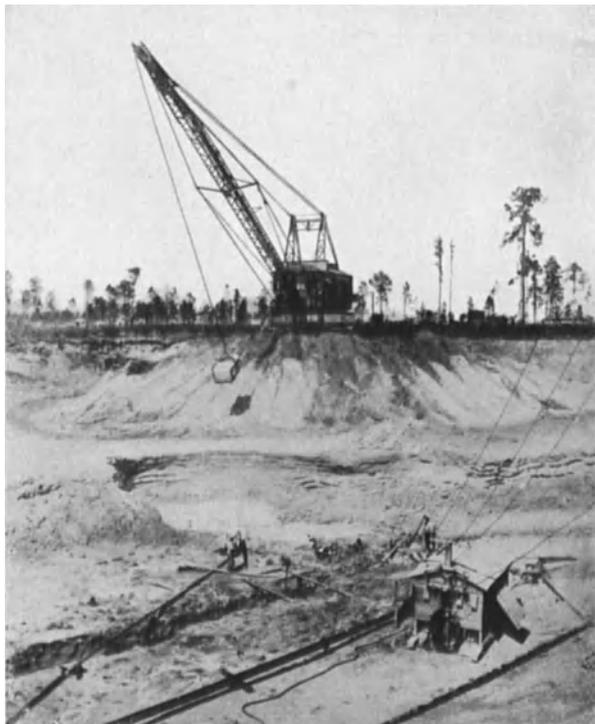
Abb. 94. Gewinnung von Pebble-Phosphat auf hydraulischem Wege, oberhalb der phosphatführenden Schichten ein Greiferkran zur Entfernung des Abraumes.
