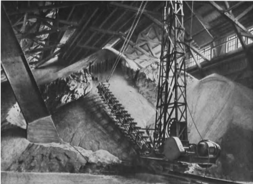
Abb. 73. Magazin mit Kratzer zum Ausspeichern der Fabrikate.
