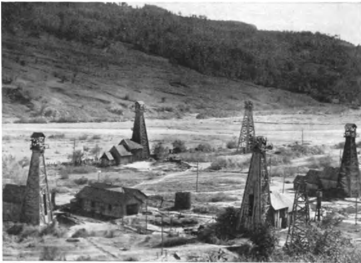
Abb. 28. Schlagbohrungen im Doftana - Tal bei Câmpina, Rumänien. Hinter den Bohrtürmen, die dem Ein- und Ausfordern des Bohrgestänges und der Bohrrohre dienen, stehen die Häuschen mit den Maschinenanlagen.
