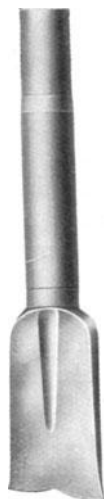
Abb. 29. Fischschwanzmeißel für Rotarybohrungen. Der Meißel hängt an dem dicken, hohlen Bohrgestänge, durch das die Spülung hinuntergepumpt wird.
