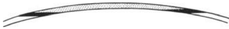
Abb. 9. Verteilung von Wasser (weiß), Erdöl (schwarz) und Erdgas (gepunktet) in einer Sandschicht. Die Dicke der Schicht ist im Verhältnis zur Länge hundertmal vergrößert.
