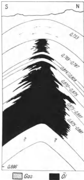
Abb. 13. Ventura Avenue Öl-feld, Kalifornien. Kegelförmiger Umriß der Ölprägungen, darüber Gaskappe mit Leichtöl. Das spezifische Gewicht des Öls nimmt nach oben ab (Ziffern am rechten Rand). Der Strich am linken Rand gibt ungefähr die Tiefe von 2960 m an, in der die Ass. Oil Co. Lloyd 83 ein Öl von d = 0,896 fand. Nach Hertel.
