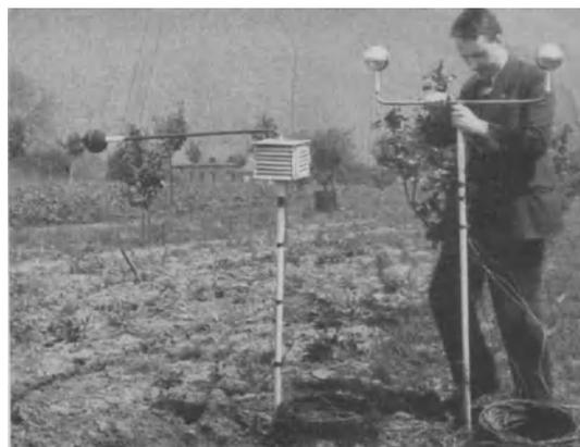
Abb. 210. Schwarzkuugel nach Linke zur Registrierung der Gesamtstrahlung, Blankkugel nach Dubois zur Registrierung geringer Windstärken.
