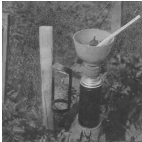
Abb. 204. Eichvorrichtung für Thermobatterien.
