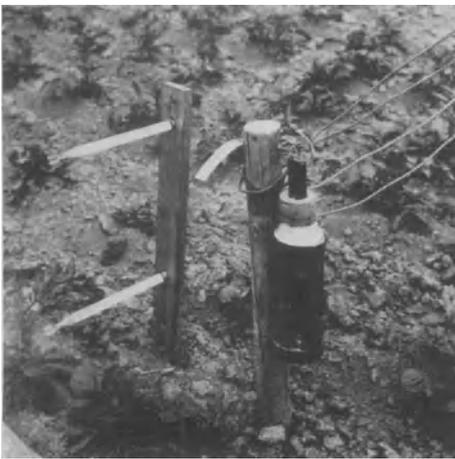
Abb. 203. Meßstelle mit zwei Glasthermometern, einem elektrischen Widerstandsthermometer und einer Thermobatterie.
