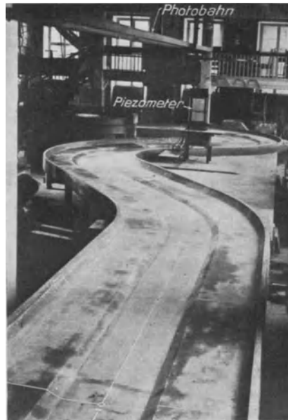
Abb. 4. Das Modell mit den Meßeinrichtungen. Maßstab der Längen und Breiten 1:500. Maßstab der Höhen 1:100.
