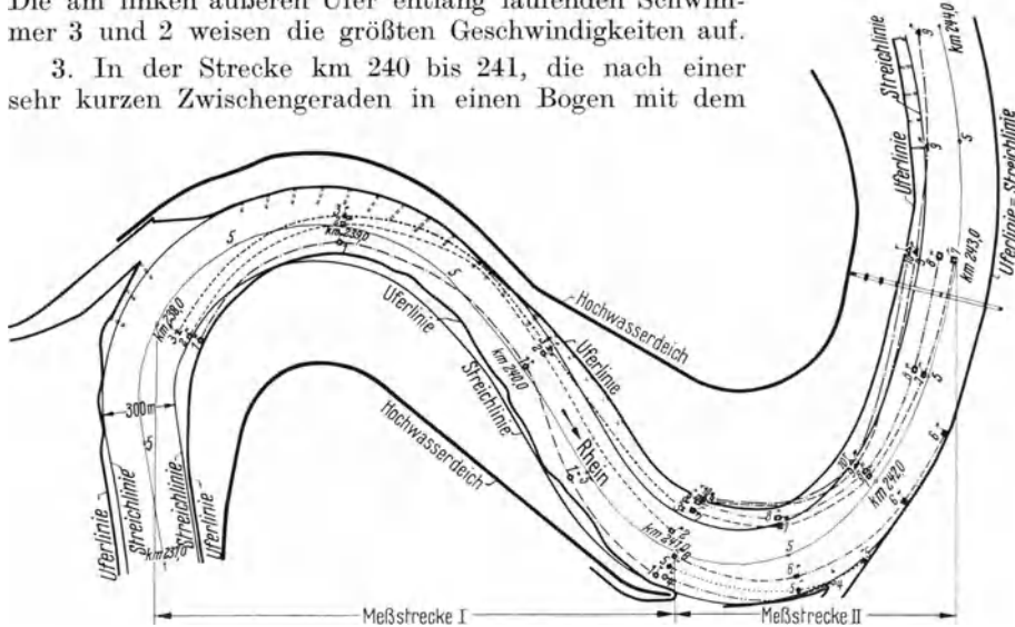
Abb. 10. Niederrheinstrecke km 238 bis 243 (Düsseldorf); Schwimmerbahnen.
