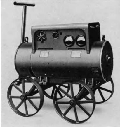
Abb. 44. Fahrbarer Schweißgenerator (Kjellberg).
