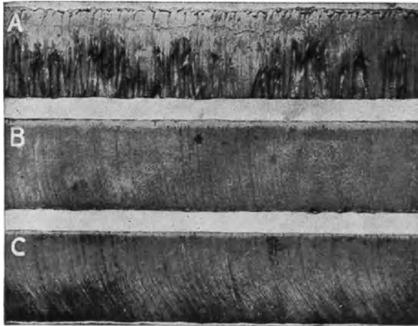
Abb. 30. Aussehen von Brennschnitten.
