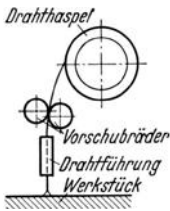
Abb. 49. Schema des Draht-Schweißautomaten.
