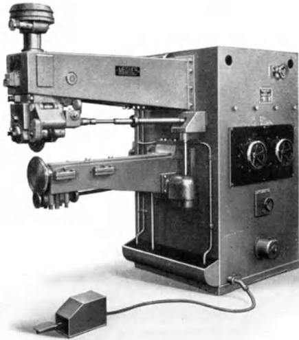
Abb. 13. Nahtschweißmaschine (Messer & Co.).
