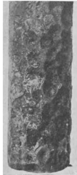
Abb. 18. Förderrohr. Bei *a* viel stärkere Korrosionen als auf Seite *b*. Wahrscheinlich durch nicht konzentrisches Einbauen der Rohre verursacht. Nach U. S. Bur. of Mines Bull. 233.
