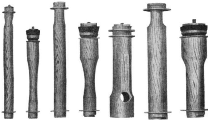
Abb. 39. Holzpflocke für das Zementierverfahren. Nach Perkins.
