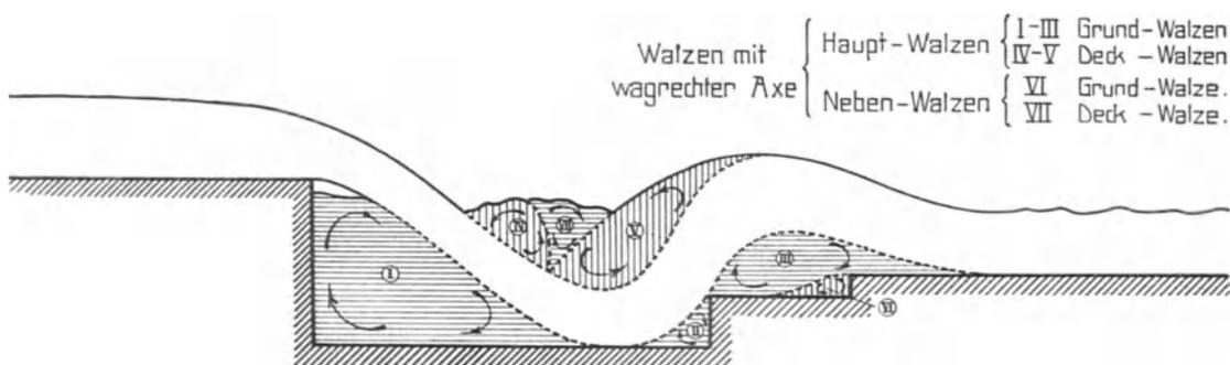
Abb. 20. Längenschnitt einer Absturzschwelle mit Grund- und Deckwalzen.
