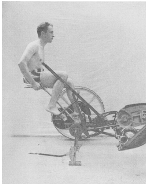
Abb.50. Mähmaschine. Ausgangsstellung für das zweite Durchtreten des Fußhebels.
