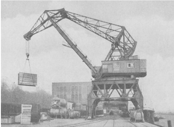
Abb. 103. Wippkran nach Abb. 102 in Ausschwenkstellung (Demag).
