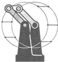
Abb. 140. Paralleldoppelkurbel- getriebe. Unverän- derte Weiterleitung von Drehbewegung.
