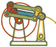
3. trägt versetzte Parallelkurbelgetriebe (Winkelkurbeln)
