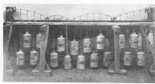
Abb. 3. Bogen nach dem Ausknicken
