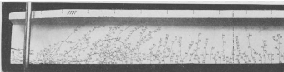
Abb. 26. Balken 1117 mit voller Schubsicherung
