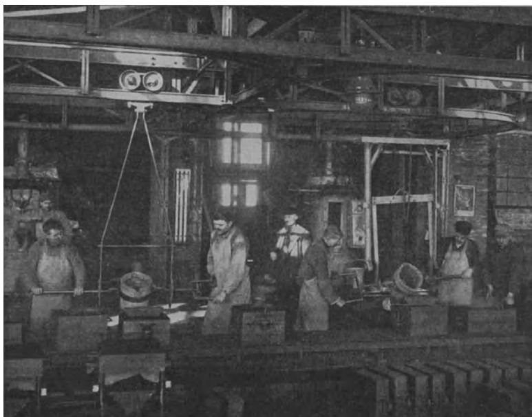
Abb. 24. Gießstrecke am Fließband (Vermeidung von Haltearbeit).
