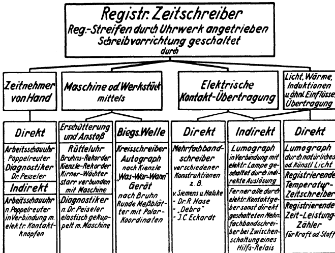
Abb. 138. Registrierende Zeitschreiber. Antrieb und Schaltung.
