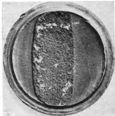
Abb. 64. Bruchfläche einer Automobilblachse.
