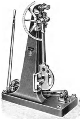
Abb. 43. Pendelschlagwerk (Schopper).
