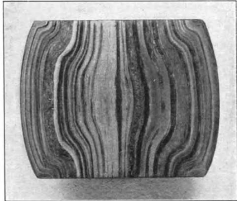
Abb. 27. Druckprobe aus Schweißisen, makroskopisch geätzt.
