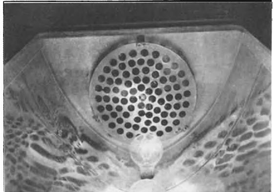
Abb. 61. Blick in den Rückstrahler des in Abb 60 gezeigten Durchleuchtungsapparates. (Aufn. d. Verf.)
