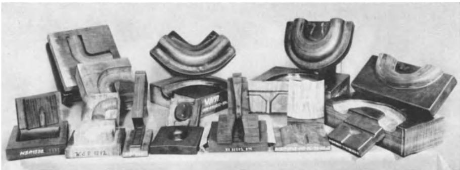
Abb. 84. Kleinziehwerkzeuge aus Lignofol: Rohrkrümmer, Abzweigungen, Verkleidungskappen u. dgl. (JFM.)
