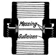
Abb. 27. Rohrkupplung.
