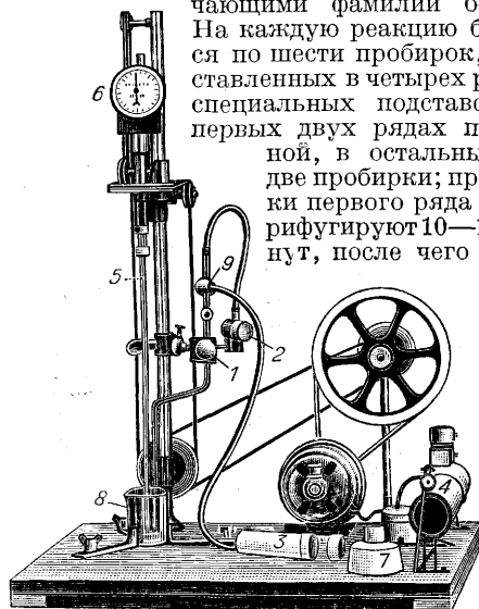
Рис. 2. Аппарат-смеситель: 1—капиллярная градуированная пипетка для перетиноля емкостью в 3 см^3 ; 2—регулятор скорости стока перетиноля; 3—шприц для всасывания в пипетку перетиноля; 4—реостат; 5—стеклянная вращающаяся палочка для смешения жидкостей; 6—тахиметр, определяющий скорость вращения этой палочки; 7—штесель реостата; 8—цилиндрический стакан с плоским дном, в к-ром готовится коллоидальная взвесь; 9—кран, регулирующий сток жидкости.
