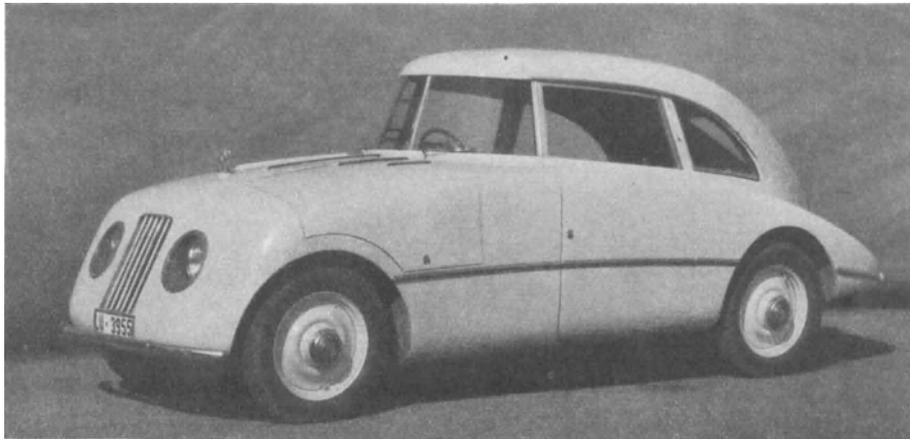
Abb. 12. Aerodynamisch günstig ausgebildeter Kraftwagen (Mercedes-Benz Typ 200 als Jaray-Stromlinien-Limousine)
