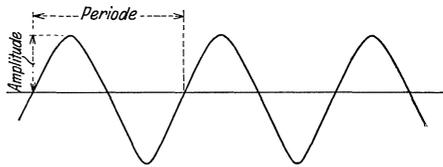
Abb. 3. Sinusoidale Stromkurve.
