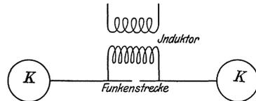
Abb. 6. Darstellung der Vergrößerung der Aufnahmefähigkeit eines schwingenden Systems durch Kondensatoren (K).
