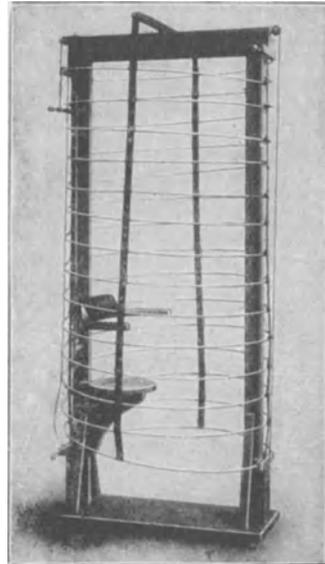
Abb. 29. Solenoid in Holzgestell, zum Hochziehen angeordnet, für Autokonduktion. (Siemens & Halske.)
