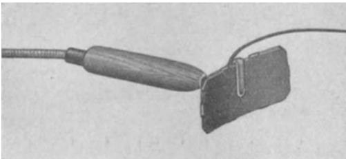
Abb. 63. Hautthermometer zur Verwendung unter einer Plattenelektrode.
