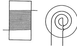
Abb. 11. Ansicht einer Hoch- und einer Flachspule.
