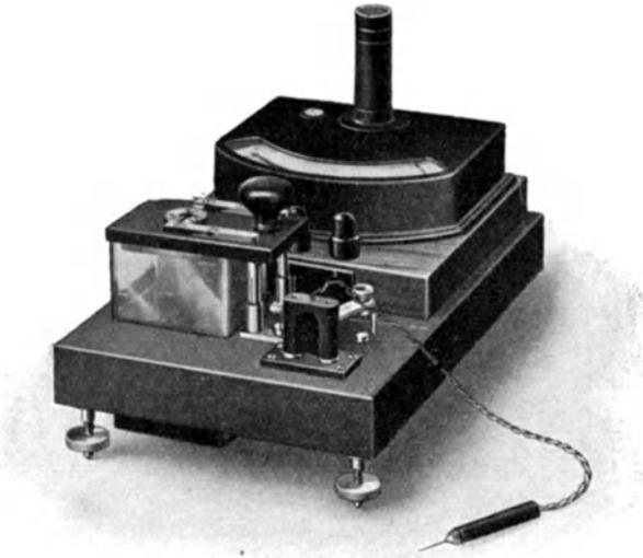
Abb. 62. Temperaturfernmeß- und Registrierapparat von Siemens mit Thermo-Nadel.
