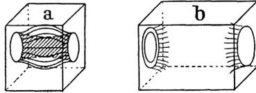
Abb. 40. Schema der Streuung der Diathermiekraftlinien im Gewebe, durch Koagulation an einem Fleischstück kenntlich gemacht.
