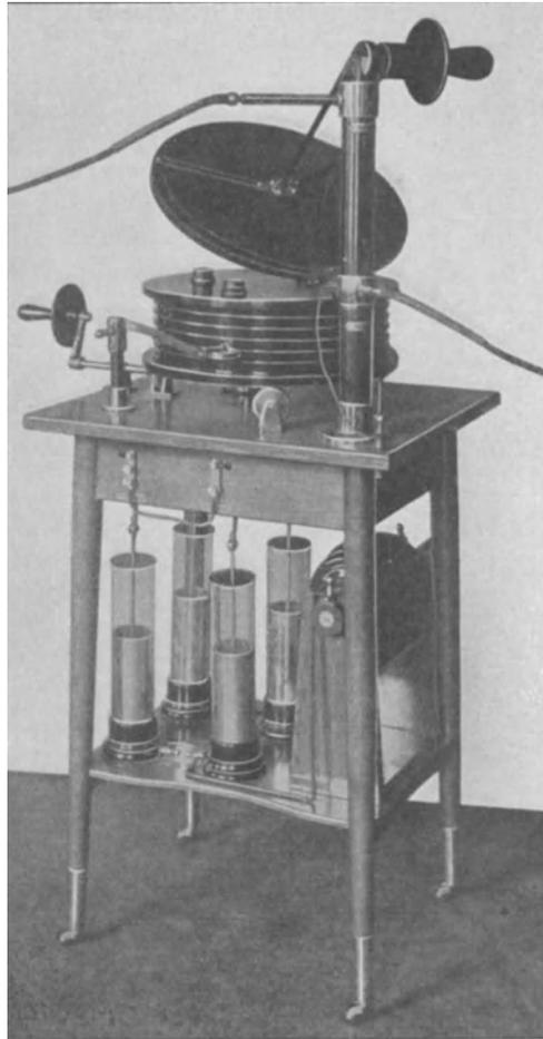
Abb. 16. Sanitas Hochfrequenzapparat für bipolare Applikation mit zwei Paaren von Kondensatoren (Flaschen). Nach Nagelschmidt.
