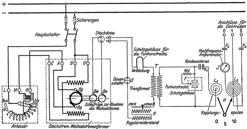
Abb. 17. Siemens'scher Diathermieapparat nach Nagelschmidt.
