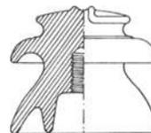
Abb. 421. Durchschlagssicherer Stützisolator.
