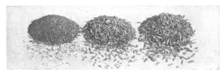
Abb. 39. Härtematerial für Stahlbeton nach Kleinlogel.
