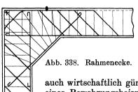
und Haftfestigkeit findet. Dabei ist eine für die Baustelle praktische Zusammenführung der Eisen von Riegel zu Pfosten sehr gut möglich. Wenn sie auch u. U. eine gewisse Überbewehrung des Eckgebietes zur Folge haben kann, so ist sie gegenüber einem zu weit gehenden Spartrieb an Eisenlängen nicht nur konstruktiv, sondern oft
