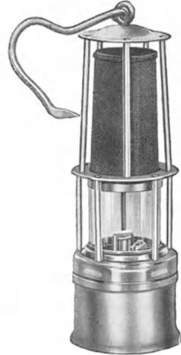
Abb. 820. Benzinsicherheitslampe. M. 1 : 4. Bild: Seippel.
