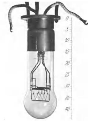
Abb. 1120. 55 V 3,2 kW-Glühlampe für Muldenspiegel mit Großkernwendelleuchtkörper. Brennlage: Sockel oben.
