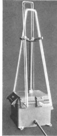
Abb. 1110. Neonhindernisfeuer mit Reserveröhre, die sich beim Ausbrennen der ersten Röhre selbsttätig einschaltet. Länge der Leuchtröhren je 2 m, Energiebedarf je 70 W.
