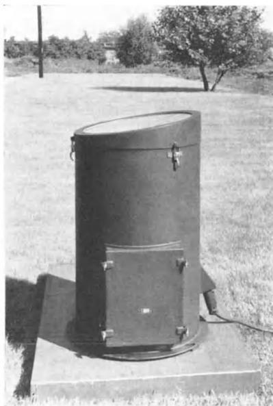
Abb.1130. Scheinwerfer zur Messung der Wolkenhöhe. Spiegeldurchmesser 50 cm.
