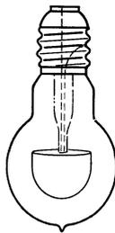
Abb. 131. Gleichstromglimmlampe früherer Bauart.
