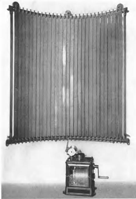
Abb. 1078. Otterblenden durch Uhrwerk angetrieben.
