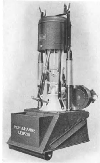
Abb. 586. Punktlichtkopierbogenlampe mit Brennerkopfkühlung (Hoh & Hahne).
