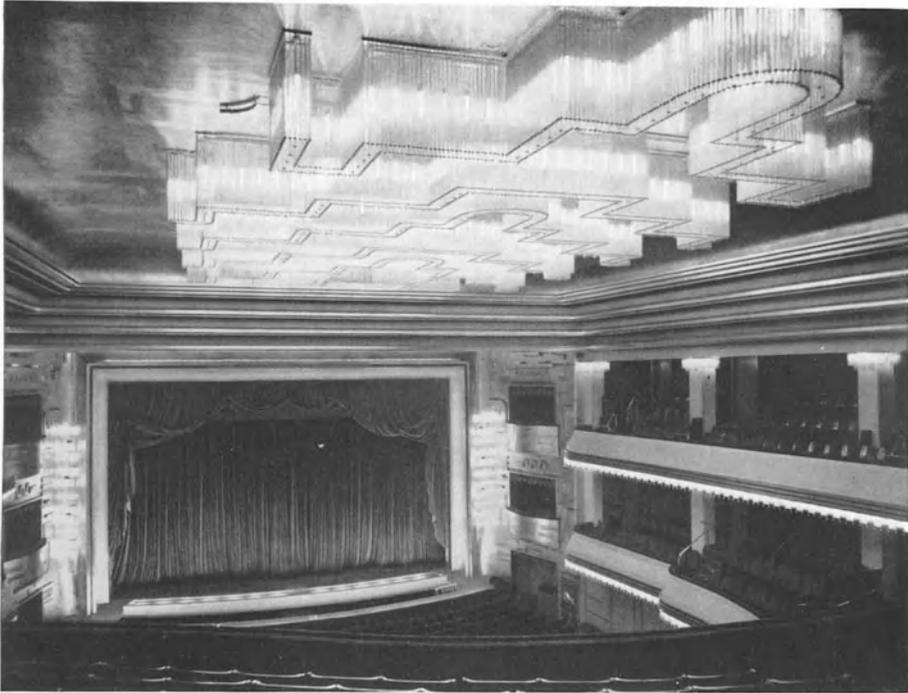
Abb. 764. Theaterzuschauerraum-Beleuchtung durch Soffittenlampen.
