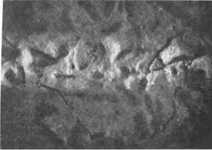
Abb. 927. Oberflächenstruktur von Bitugrus (Teerdecke), aufgenommen bei flach einfallendem Licht. (WEIGEL u. SCHLÜSSER: Licht 1935.)
