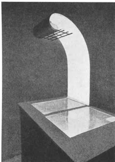
Abb. 747. Beleuchtungseinrichtung zur Oberflächenprüfung blanker Feinbleche. (Aus Licht 1932.)
