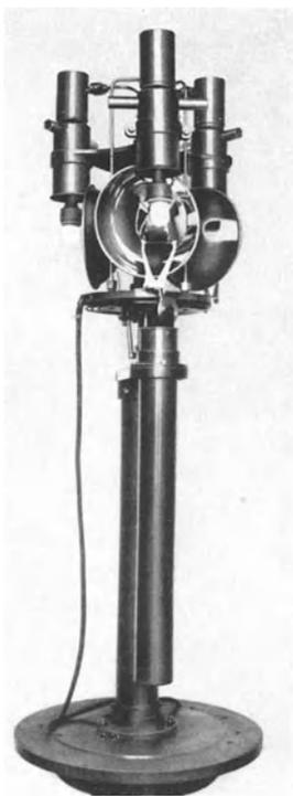
Abb. 1086. Wechselvorrichtung für Flüssiggasbrenner.
