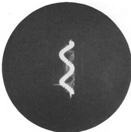
Abb. 1066. Dreifachwendeldraht-Lampe.
