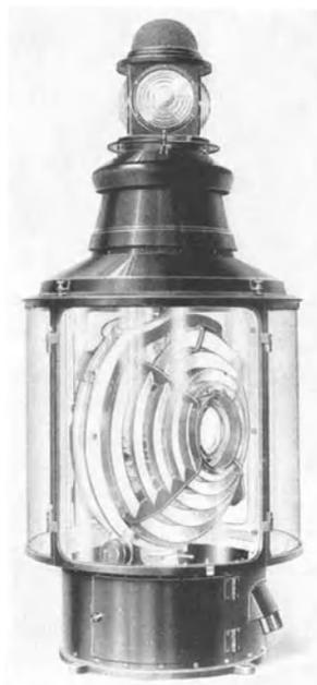
Abb. 1099. Umlaufendes Flughafensteuerungsfeuer und Flugstreckenhauptfeuer mit Glasparabolspiegel von 60 cm Durchmesser und Projektionslampe Form B 110 oder 220 V, 1000 oder 1500 W (vgl. Abb. 1104).
