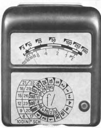
Abb. 403. Sixtus-Belichtungsmesser. Werkphoto P. Gossen, Erlangen.
