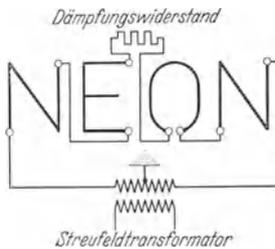
Abb. 867. Prinzipschaltung einer Leuchtröhren-Anlage mit Streufeldtransformator und Dämpfungswiderstand.
