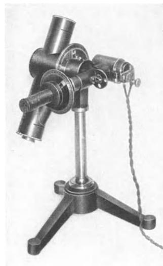
Abb. 356. Polarisationsphotometer nach MARTENS (Schmidt & Haensch, Berlin), Ansicht.
