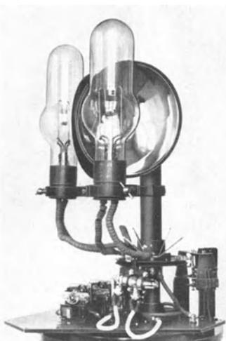
Abb. 1088. Lichtquellenwechselvorrichtung für Glühlampen.
