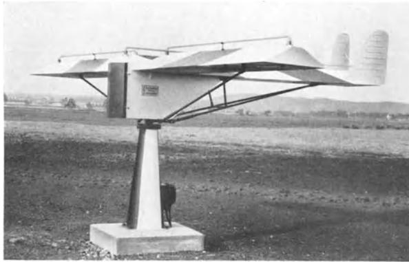
Abb. 1112. Landerichtungsanzeiger mit Quecksilberrohren. Gesamtlänge der Röhren etwa 8 m. Energiebedarf 420 VA.
