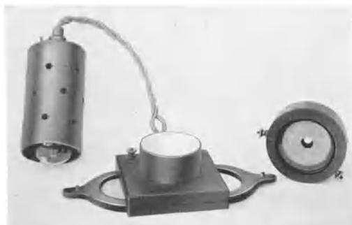
Abb. 385. Lichtelektrischer Reflexionsmesser (Tungsram).
