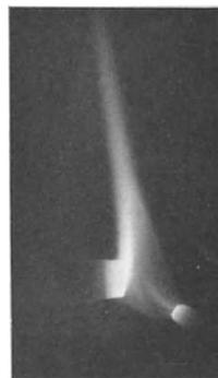
Abb. 97. Lichtbogen zwischen Beckkohlen + 12 — 9 mm Durchmesser bei 100 A Gleichstrom von der Seite gesehen.
