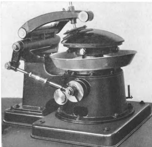
Abb. 633. Poliermaschine für große Scheinwerferspiegel. (Firma O. Ahlberndt, Berlin.)
