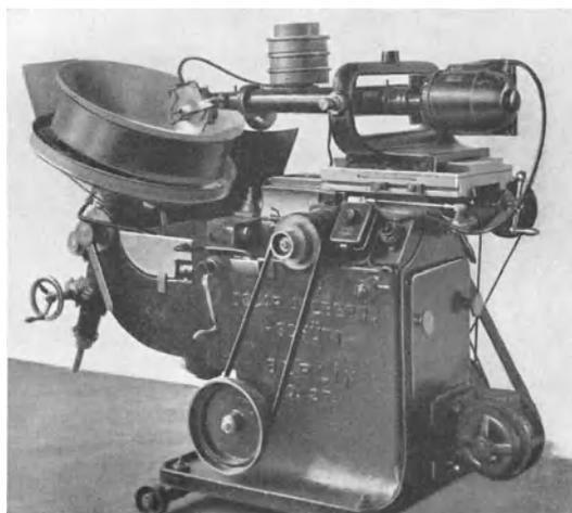
Abb. 631. Vorschleifmaschine für große Scheinwerferspiegel.
