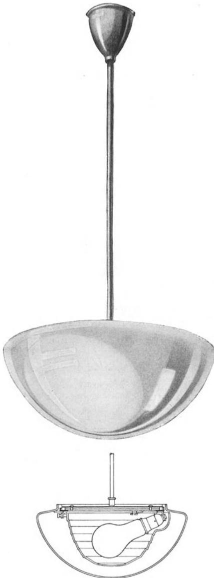
Abb. 511. Leuchte mit Glassilberspiegel für ganzindirektes Licht. Ansicht und Schnitt (Zeiß Ikon).
