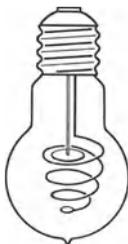
Abb. 132. Gleich- und Wechselstromglühlampe früherer Bauart.
