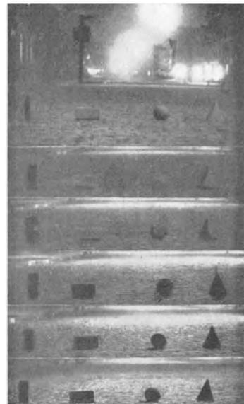
Abb. 1167. Einfluß örtlicher Ungleichförmigkeit der Straßenbeleuchtung auf Wahrnehmbarkeit und Auffälligkeit von Hindernissen auf der Fahrbahn.
