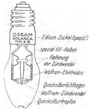
Abb. 1192. Osram-Solarcalampe (Innenaufbau).
