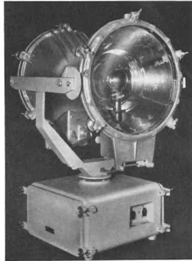
Abb. 1106. Zweistrahliges Platzfeuer mit umlaufenden Parabolspiegeln von 50 cm Durchmesser und 1000 W-Projektionslampen.
