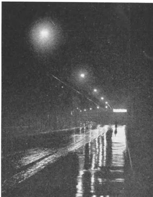
Abb. 1172. Beispiel einer Glanzreflexverbreiterung. Der durch das über die Straße gespannte Lichtband erzeugte breite Glanzstreifen auf der Fahrbahn verhindert eine Tarnung selbst unbeleuchteter dunkler Hindernisse.
