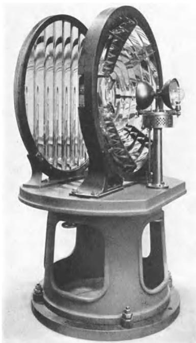
Abb. 1067. Streuer, Linse, Lichtquelle mit Kugelspiegel. Leuchtfener Pellworm.
