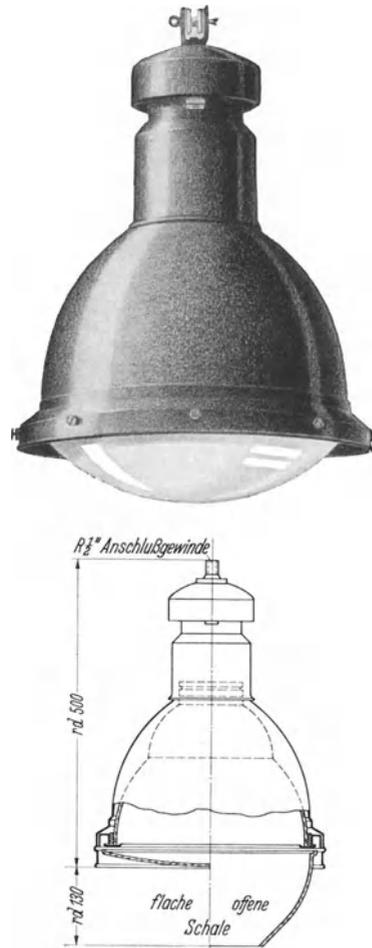
Abb. 512. Glassilberspiegel-Breitstrahler für Hallen- und Außenbeleuchtung. Ansicht und Schnitt (Zeiß Ikon).
