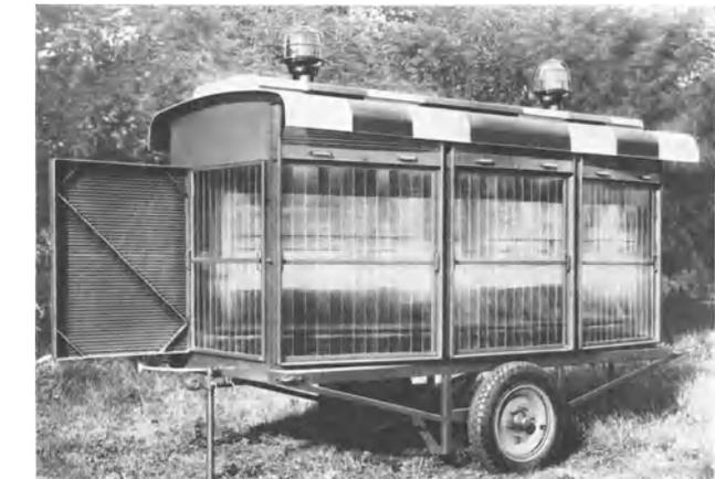
Abb. 1118. 26 kW-Landebahnleuchte mit Zylinderparabol-(Mulden-) Spiegel mit 8 Glühlampen der Abb. 1120 und Hindernisdachlichtern, als Anhänger.
