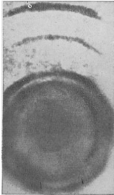
Abb. 23. Elektronenbeugung an Silber 186 V.
