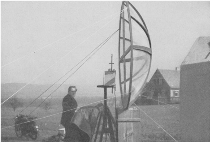
Abb. 62. Ultra-Kurzwellensender mit 14 cm-Wellen nach K. KOHL.
