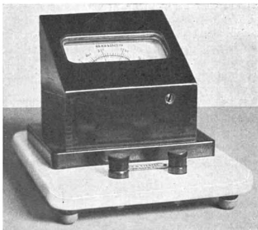
Fig. 253. Hitzdrahtperemeter zur Ohr- und Augendiathermie.
