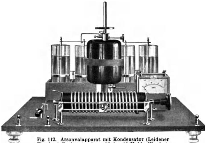
Fig. 112. Arsonvalapparat mit Kondensator (Leidener Flaschen), Funkenstrecke und Solenoid (Veifa-Werke).
