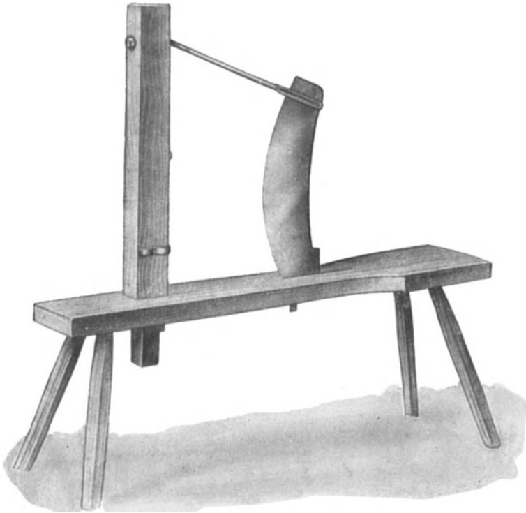
Abb. 151. Kürschnerbank mit Fleischmesser
