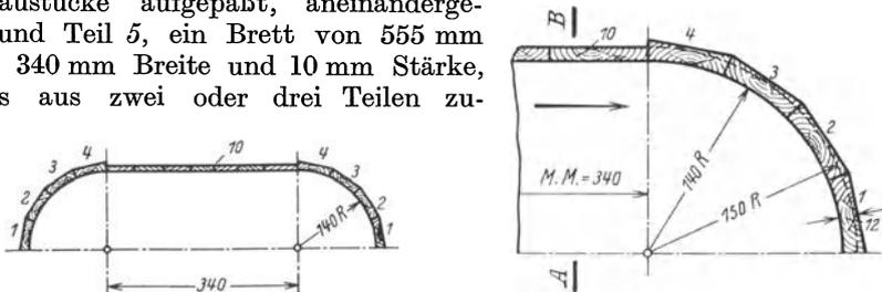
Abb. 122. Modellaufbau zum Zwischenflansch nach Abb. 121.
