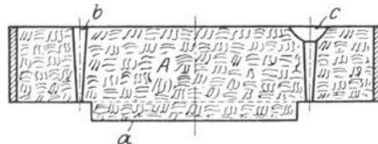
Abb. 407. Fertiger Oberkasten.
