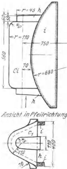
Abb. 587. Loser Modellteil  $C_1$  zum Einsetzen in den Mantelkasten  $E$  (Abb. 585).
