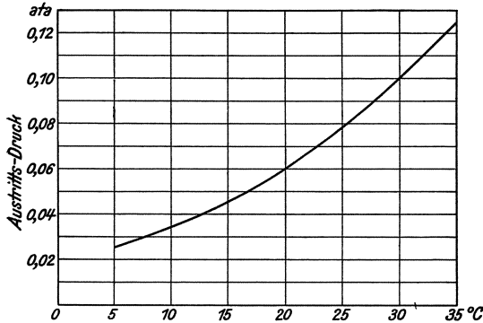
Abb. 40. Druck am Turbinenausritt in Abhängigkeit von der Kühlwasser-Eintrittstemperatur. (Mittelwerte für 60- bis 70fache Kühlwassermenge.)
