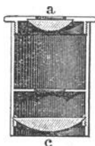
Durchschnitt eines negativen oder Huygens'schen Oculars.
