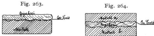
Nach dem Erstarren trennt man durch Einsetzen einer Messerklinge die ursprünglichen Modelle a und b und erhält auf diese Weise ein von zwei Seiten zu reproduzierendes Kupfermodell mit einer Gipszwischen­schicht, das nach dem Entfetten und Herstellung einer Trennungsschicht zur galvanoplastischen Reproduktion in das heiße Nickelbad eingehängt wird. Nachdem zum Schluß die dünne Kupferschicht von den erhaltenen Nickelgalvanos abgezogen ist, erhält man zwei gebrauchsfertige Gießformen in Nickel.
