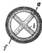
3. Eine Vorrichtung der durch den Anspruch 2 gekennzeichneten Art, bei der die Kerne hohl und an einem oder beiden Enden offen sind und der an der Außenwand der Kerne sich ablagernde Niederschlag durch Platten, die an der Innenwand der Kerne abgelagerte Niederschlag durch einen oder mehrere Rahmen verbundene Walzen verdichtet wird.
