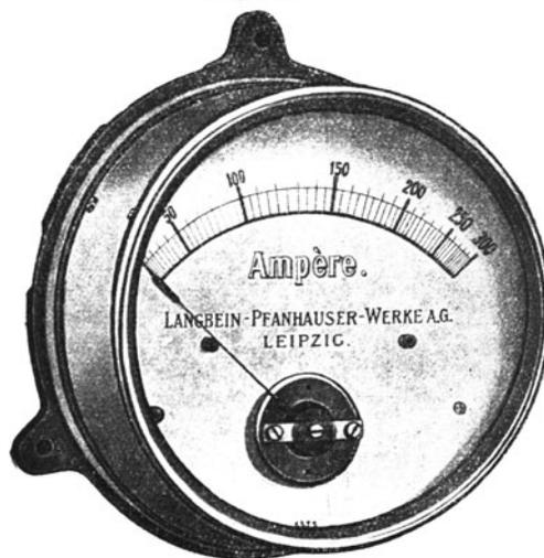
Elektromagnetischer Ampermesser (Strommesser).
