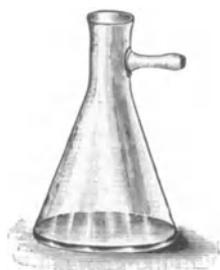
Fig. 17. Filtrierkolben.
