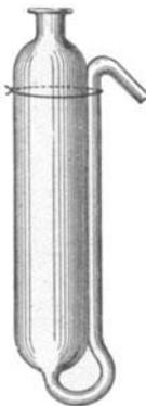
Fig. 10. Absorptionsgefäß nach Henz.
