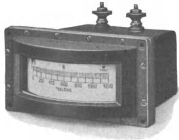
Fig. 117. Zeigergalvanometer.
