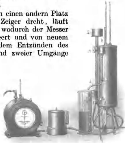
Fig. 37. Gascalorimeter von Junkers.
