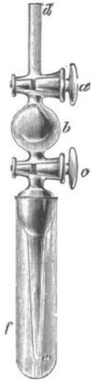
Fig. 26. Kugelhahnpipette von Lunge und Rey.
