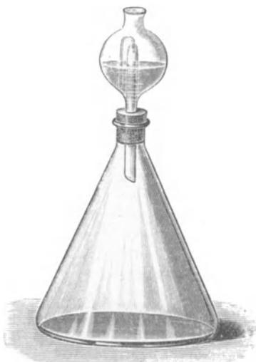
Fig. 55. Reduktionskolben mit Contatventil.
