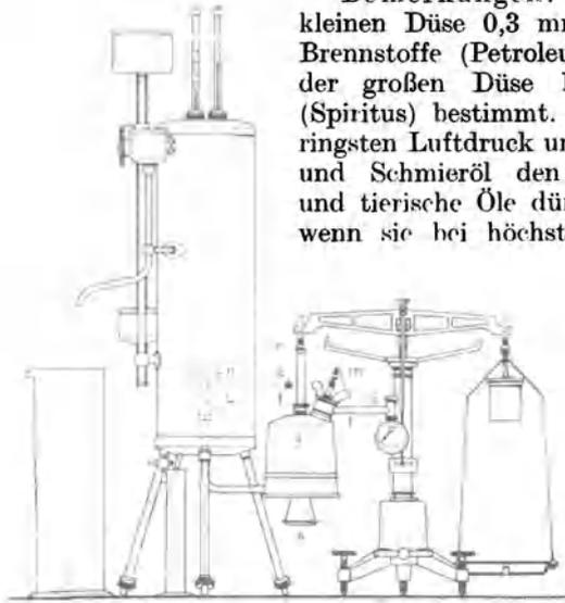
Fig. 38. Flüssigkeitscalorimeter von Junkers.
