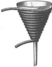
Fig. 21. Heißfiltrations-trichter.
