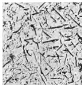
Abb. 42. Stickstoffnadeln (Nitridnadeln) einer Lichtbogenschweißung. 500 ×.
