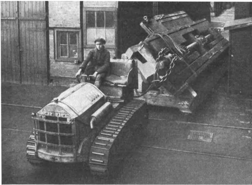
Abb. 113. Raupenschlepper von 25 PS auf dem Fabrihof (Hanomag). TWL 6185.
