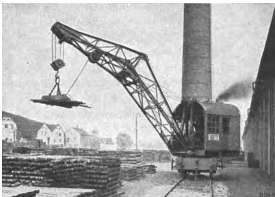
Abb. 171. Drehkran mit Verlademagnet (Demag).
