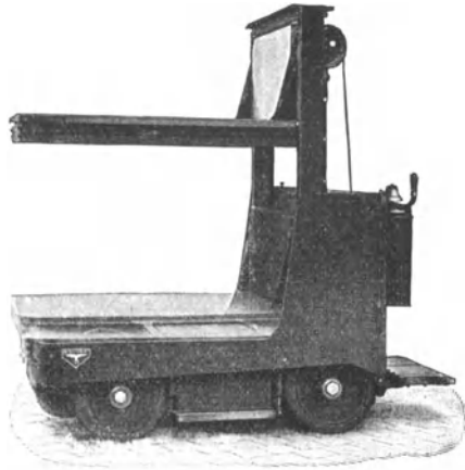
Abb. 81. Elektrostapler „Eidechse“ (Bleichert). Hubhöhe 1,65 m. Größte Belastung am freitragenden Ende 500 kg. TWL 10106.
