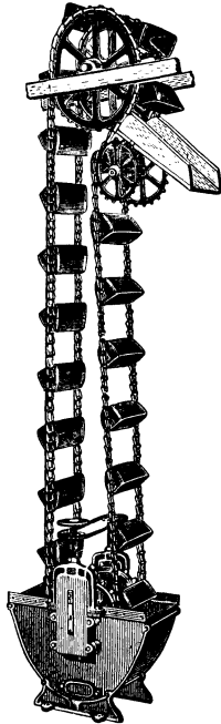
Abb. 63. Senkrecht stehender, langsam laufender Elevator mit eingezogenem Becherstrang.
