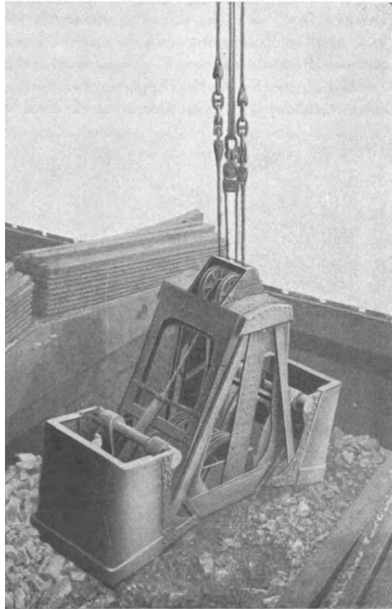
Abb. 168. Selbstgreifer beim Entladen von Erzen (Tigler).
