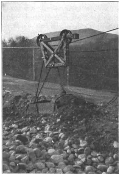
Abb. 170. Schürfkübel eines Haldenkabelkranes (Bleichert).
