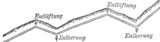
Abb. 39. Druckleitung mit Gegengefällen.
