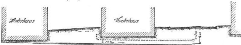
Abb. 14. Entwässerung eines von der Straße abfallenden Grundstückes.
