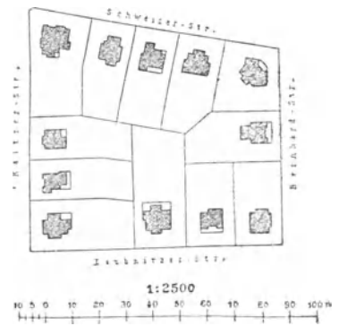
Abb. 21. Offene Bauweise (Dresden).
