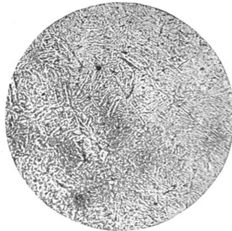
Abb. 10. Stahl mit 0,95% C, bei 900° C in Wasser abgeschreckt. Martensit.
