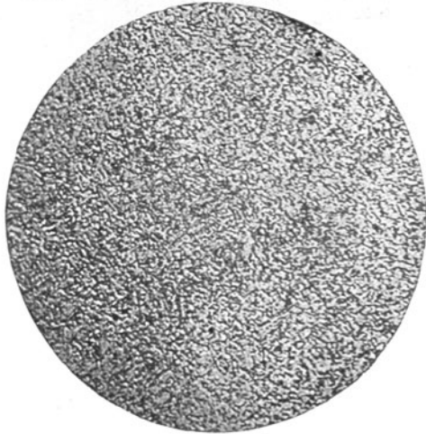
Abb. 19. Bei 700° C angelassen. (Körniger Perlit.)
