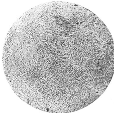
Abb. 11. Stahl mit 0,95% C, bei 900° C in Wasser abgeschreckt, bei 100° C angelassen.
