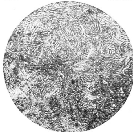
Abb. 12. Stahl mit 0,95% C, bei 900° C in Wasser abgeschreckt, bei 200° C angelassen.
