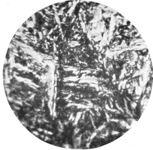
Abb. 14. Bei 275° C angelassen. Troostit.
