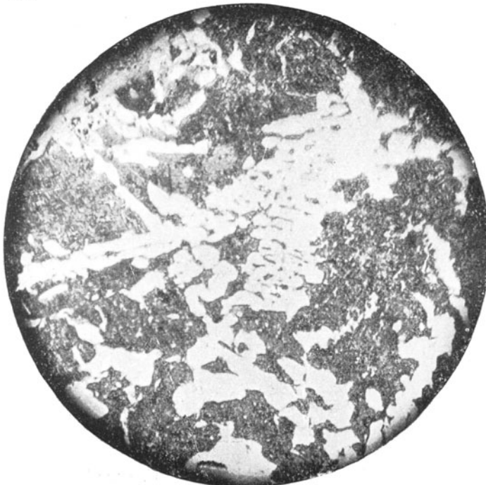
Abb. 7. Stahl, gegossen, mit 2,08% C. Perlit und Zementit.
