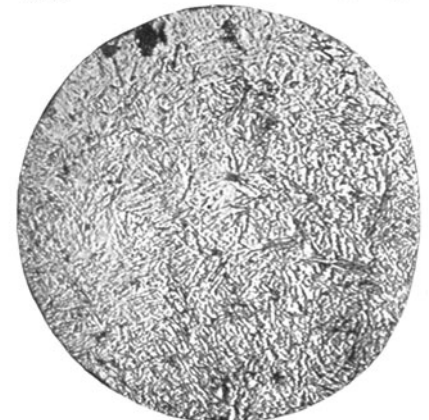
Abb. 8. Stahl mit 0,95% C bei 900° C in Wasser abgeschreckt. Martensit.
