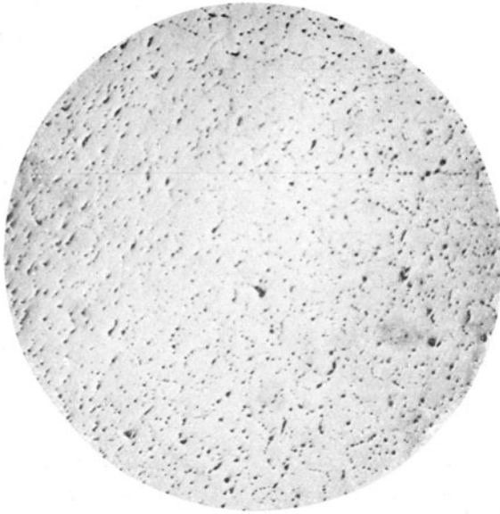
Abb. 58. Temperkohle in einem längere Zeit in Holzkohle geblühten Werkzeugstahl (nach Ledebur).
