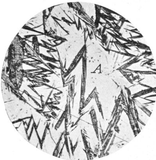
Abb. 52. durch Abschreckung erzielter Austenit (elektrolytisch mit Salzsäure geätzt).
