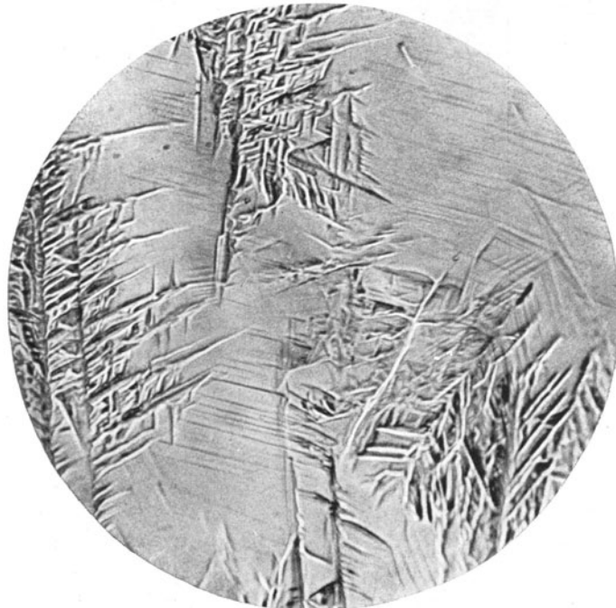
Abb. 53. Ursprünglicher Austenit durch Eintauchen in flüssige Luft in Martensit umgewandelt. Abb. 53. Ursprünglicher Austenit durch Eintauchen in flüssige Luft in Martensit umgewandelt.
