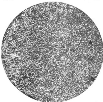
Abb. 17. Bei 500° C angelassen. Sorbit.
