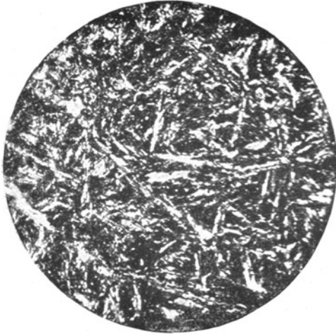
Abb. 13. Bei 275° C angelassen. Troostit.
