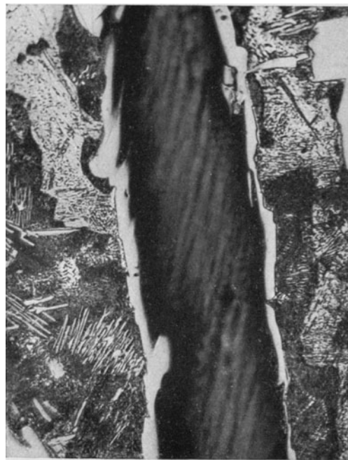
Abb. 56. Graphitausscheidung in hochmanganhaltigem Spiegeleisen (nach Osann). Gesamt-C = 5,19%; davon Graphit = 1,80%; Mn = 9,61%.
