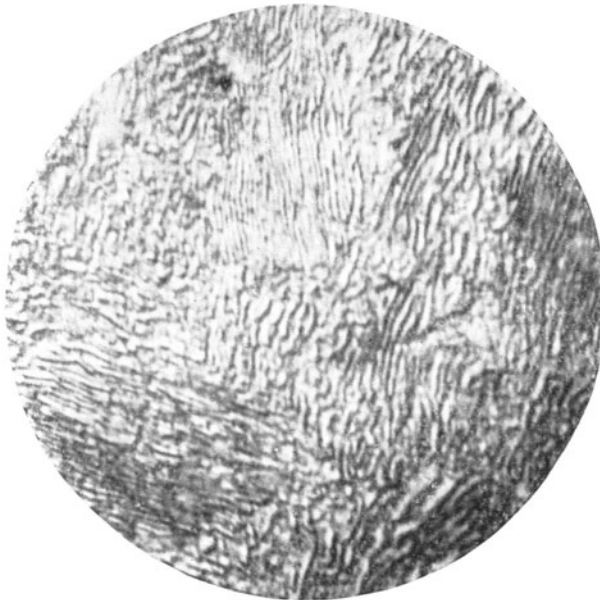
Abb. 5. Eisen mit 0,95% C, gewalzt. Perlit (mit alkoholischer Salzsäure geätzt).
